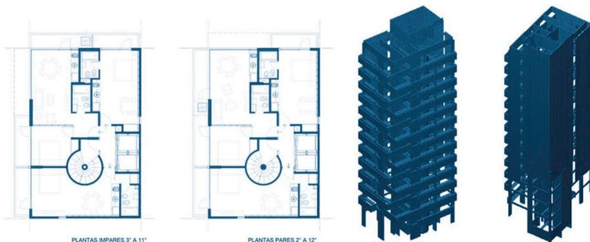
Figura 4: Propuesta original relevada. Estructura irregular en planta y en altura
