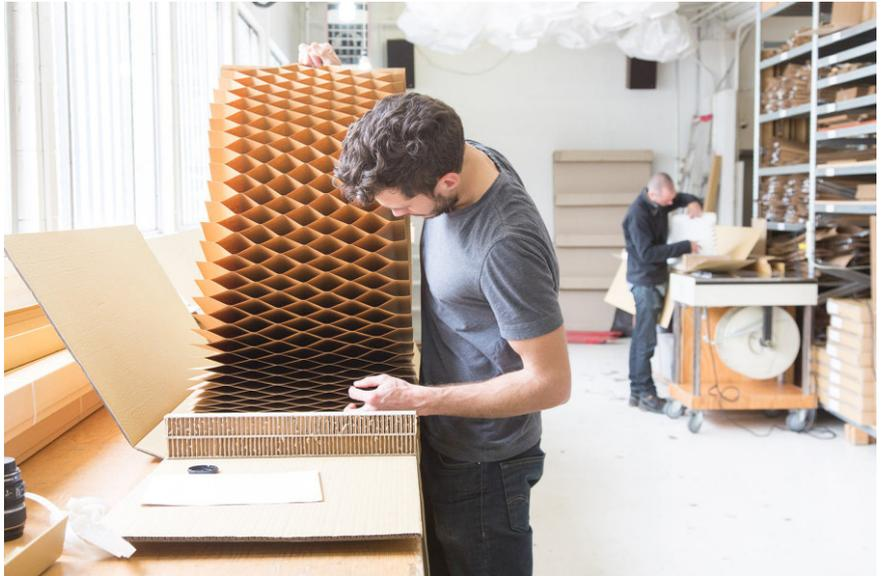
Figura 5. Muestra de estructura panel de abejas a base de papel del separador de ambientes modular paper softblock, fotografiada por Scott Rudd. Diseño: Stephanie Forsythe + Todd MacAllen. Fuente: molo.
