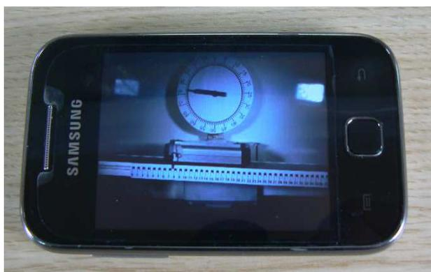
FIGURA 9: Fotogramas de una filmación de caída de un cuerpo por un plano inclinado.
