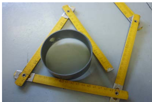
Figura 11: Metro de carpintero y poligonalización de la circunferencia.
