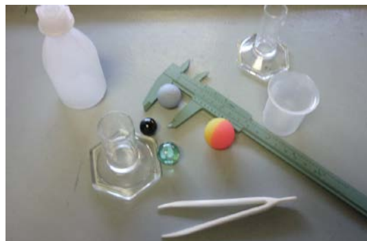
Figura 7: utensilios para la medida de la relación volumen/diámetro.
