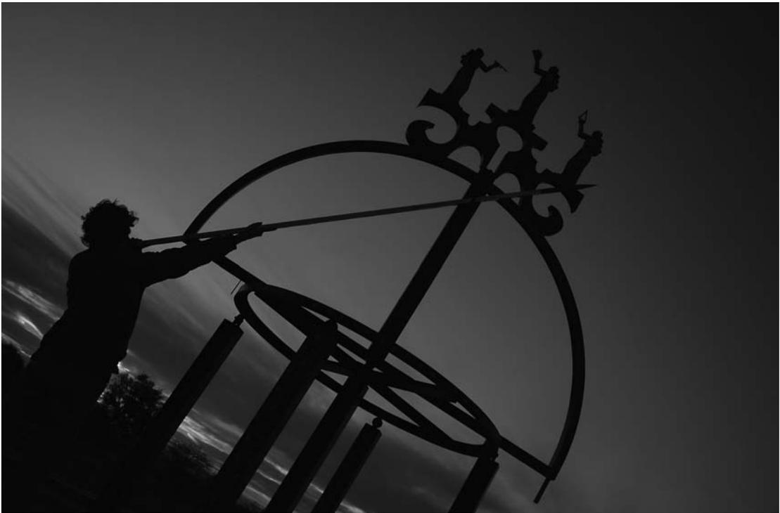
Figura 3: Un observador utiliza el Gran Semicírculo Azimutal, con el que determina la altura de un astro respecto del horizonte y lo ubica también respecto de las direcciones cardinales.
