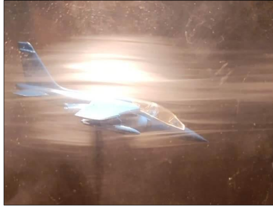
FIGURA 11. Observación de líneas de flujo sobre el modelo utilizado anteriormente pero en este caso con humo generado mediante la utilización de nitrógeno líquido.
