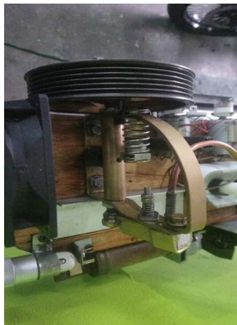
FIGURA 2. Detalle del sistema polea-cigüeñal-biela y pistón.
