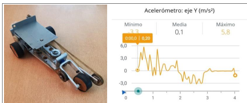
FIGURA 4. Izquierda: soporte montado al prototipo para sostener un teléfono móvil. Derecha: gráfico de aceleración en función del tiempo, obtenido con la aplicación Arduino Science Journal (se instala en dispositivos desde Play Store). Se aprecian marcadas oscilaciones (ver texto). La serie de valores negativos se corresponden con la frenada.
