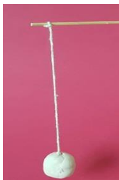
FIGURA 6. Exemplo de fio de prumo. Fonte: Santiago (2018)
