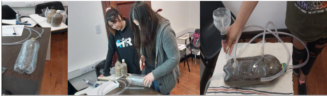
FIGURA 6. Fotos del dispositivo experimental para la modelización y estudio de la Ley de Darcy
