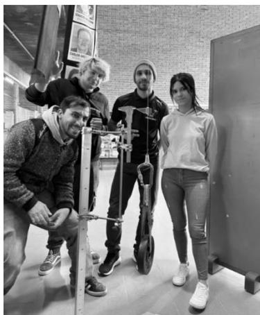
**FIGURA 3.** Foto de la parte inferior del dispositivo experimental donde se aprecia el sujetador de pesas utilizado, junto al grupo de estudiantes dispuestos para el inicio de recolección de medidas de estiramientos al colocar diferentes pesas sobre el alambre.
