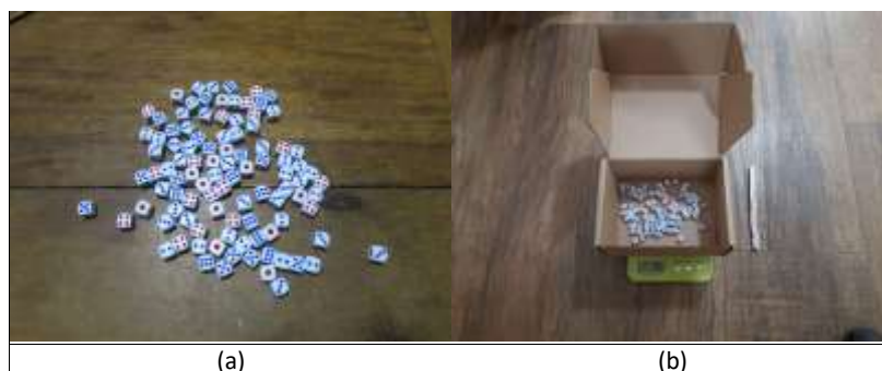
FIGURA 2. (a) Poliedros físicos de 6 faces, dados convencionais. (b) Balança de culinária para medição da massa dos poliedros remanescentes.
