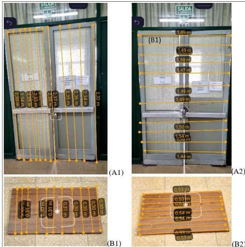
**FIGURA 3.** Reglas virtuales sobre objetos reales: A1: reglas para medir la altura de la puerta. A2: reglas para medir el ancho de la puerta. B1: reglas para medir la altura de la tabla. B2: reglas para medir el ancho de la tabla.
