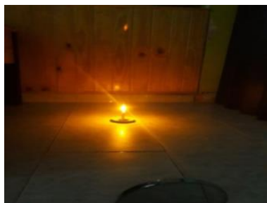
FIGURA 2: Experiencia con espejo cóncavo. Grupo N.º 1. Cohorte 2020. Distancia focal espejo, f=(62,5 \pm 0,5) cm.
