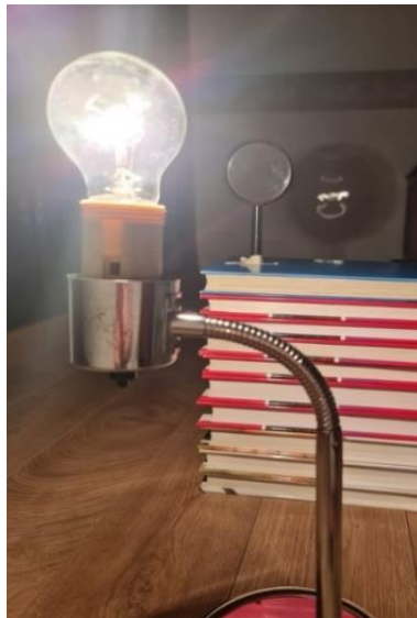
FIGURA 5: Experiencia con lentes. Grupo N.º 1. Cohorte 2021. Distancia focal lente f = (30 \pm 1) cm.
