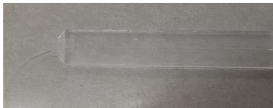
FIGURA 10. Barra del detector con fibra WLS.
