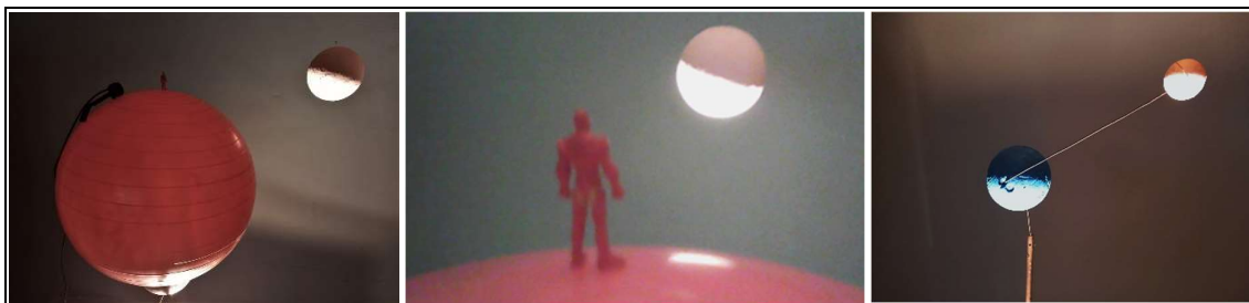
FIGURA 2. Izq. y centro: Visión espacial y terrestre de una Luna creciente modelizadas con un pequeño muñeco en el punto más alto de la pelota, detrás suyo se ubica la cámara web (toma la foto central). Der: Dispositivo rotante construido con dos esferas.
