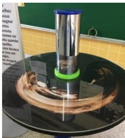
FIGURA 10. Anamorfose catóptrica cilíndrica, localizado no hall do campus , é a sétima parada da Trilha da Ciência.
