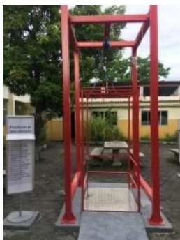
FIGURA 14. Plataforma de autoelevação, onde os visitantes podem se elevar puxando uma corrente que passa por uma talha. Detalhe para a rampa de acesso à plataforma, que permite o uso por cadeirantes.
