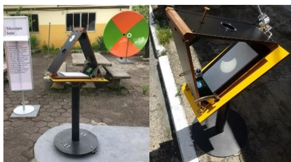
FIGURA 15. Telescópio solar é um equipamento capaz de projetar a imagem do Sol num anteparo. À esquerda o equipamento já posicionado no pátio interno do IFRJ-CVoR e à direita, sendo testado o conjunto óptico durante o eclipse solar de 2020.
