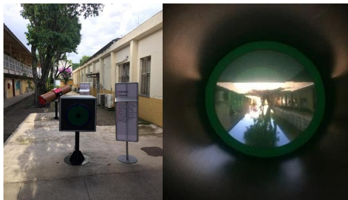
FIGURA 4. Segunda parada da Trilha da Ciência, no pátio de entrada do campus, com uma câmara escura (esq.). À direita uma fotografia da imagem invertida produzida no interior da câmera escura.
