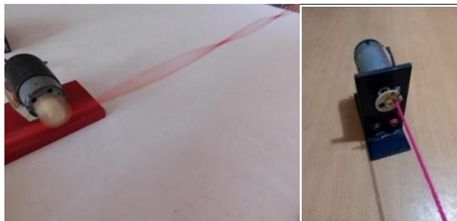
**FIGURA 6.** Actividad 7. Izq.: onda estacionaria en cuerda (hilo “Tatora” en nuestro caso) apoyada sobre la superficie de un corcho giratorio excéntrico, der.: montaje de la cuerda desplazada radialmente del eje del motor para ondas estacionarias en revolución. En ambos casos se trata de dispositivos construidos con motores de CC (extraídos de antiguas impresoras).
