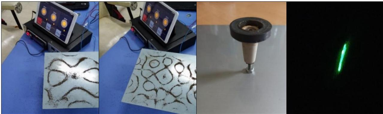
**FIGURA 3.** Actividad 3. Izq.: patrones obtenidos a 645 y a 2242 Hz; der.: soporte atornillado al centro geométrico de la placa y luego montado sobre el cono del parlante. Imagen obtenida en una pared por un haz láser abierto al apuntar un puntero sobre una zona nodal de la chapa donde se fijó con adhesivo un espejo de muy pequeño tamaño (el laboratorio fue oscurecido).
