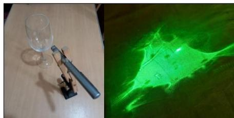
**FIGURA 5.** Actividad 5. Izq.: Láser apuntando a la copa; der.: Imagen obtenida con la luz láser refractada al atravesar la pared de la copa. Se visualiza un movimiento ondulatorio llamativo que reproduce las variaciones en amplitud que se tienen en la copa.
