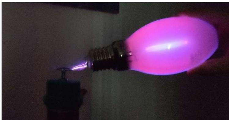
**FIGURA 15.** Descarga elétrica numa lâmpada de vapor de sódio.
