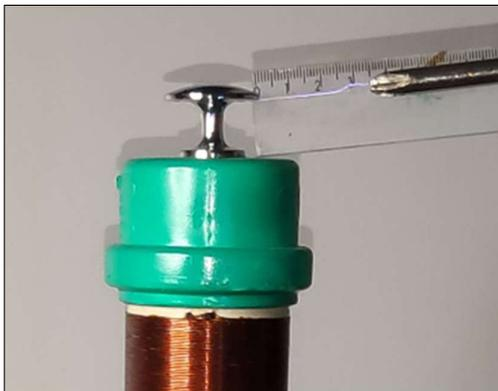
**FIGURA 14.** Comprimento do arco voltaico na bobina secundária.
