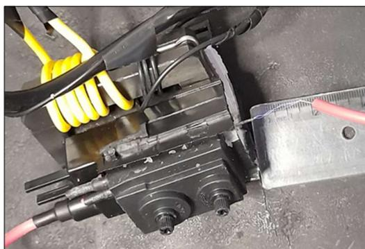
FIGURA 13. Comprimento do arco voltaico no flyback.
