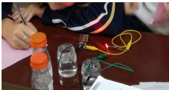
FOTO 3. Se muestran la respuesta (luz encendida e intensa) a la medición de la conductividad del agua salada.
