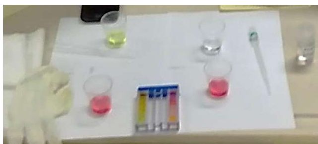
FOTO 2. Se muestran las mediciones de pH y de cloro libre residual en agua de red y en agua de surgente realizadas utilizando un kit para piscina.
