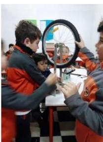
**FIGURA 4.** Los estudiantes generando corriente eléctrica a partir de un dínamo construido con una rueda de bicicleta, en una clase compartida del docente de aula y la profesora de Ciencias de la Computación.
