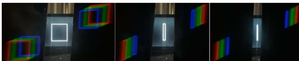
**FIGURA3.** Imagen rectangular generada y proyectada por la laptop. El espectrómetro descompone la luz blanca de la laptop en sus tres frecuencias fundamentales según el sistema RGB que utilizan las pantallas como televisores de plasma, monitores y teléfonos.
