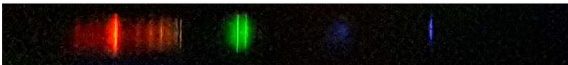
**FIGURA 5.** Espectro de emisión de una lámpara de bajo consumo o lámpara fluorescente compacta. La imagen fue recortada y aumentado su contraste para poder ver las líneas de menor intensidad
