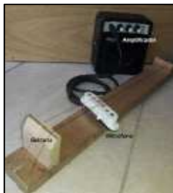
FIGURA 2. Conexiones entre: prototipo de guitarra eléctrica, amplificador, micrófono y cuerdas.
