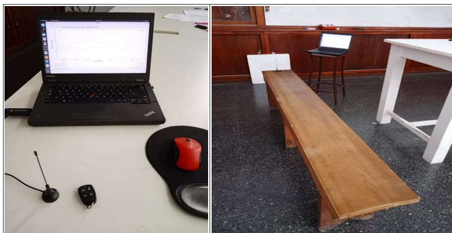
FIGURA 6. Experiencia realizada para el cálculo de la atenuación de propagación.
