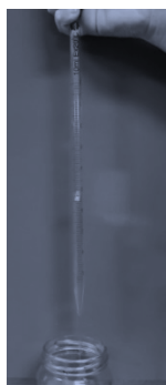
FIGURA 1. Trozo de plástico flotando dentro de la pipeta para que el Tracker pueda “seguir” el descenso.
