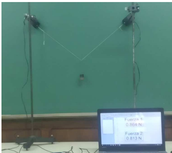
FIGURA 2. Se muestra un cuerpo sostenido por una soga. En ambos extremos superiores de la soga se colocan los sensores de fuerza. Estos elementos conectados a una interfaz y posteriormente a una PC, permiten medir la fuerza que ejercen las sogas sobre el cuerpo que cuelga.
