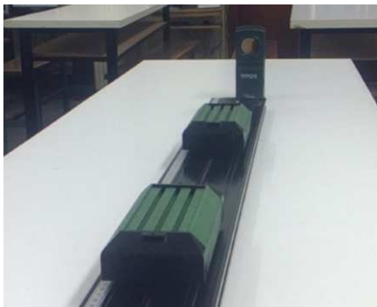
FIGURA 4. Se muestra el choque entre dos cuerpos. Al final de la pista se observa un sensor de posición que conectado a una interfaz y luego a una PC, mide la velocidad de los cuerpos.
