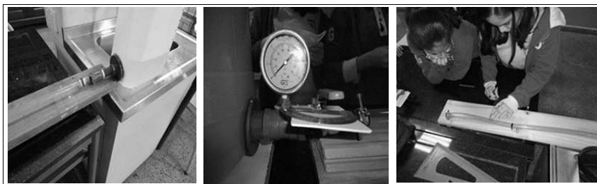
FIGURA 2. Construcción del dispositivo experimental, ubicación del manómetro con válvula esférica y registro de la escala, medida en cm.
