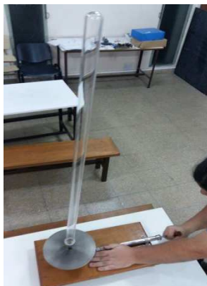
FIGURA 2. Accionando el émbolo para hacer vacío en el tubo de Newton.
