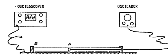
Figura 1: Esquema del equipo para medir la velocidad del sonido en el aire
