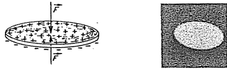
Figura 6: Cerámica piezoeléctrica: esquema y fotografía.
