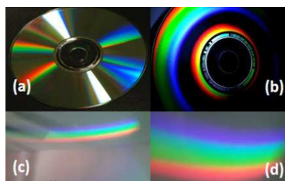
FIGURA 13. (a) y (b) Descomposición de la luz blanca por interferencia en los surcos de un CD. Figuras de libre disposición en la web; (c) Fotografía de arco iris obtenido en la pared, por reflexión de un delgado haz de luz solar sobre un DVD; (d) Detalle de la fotografía anterior (c).
