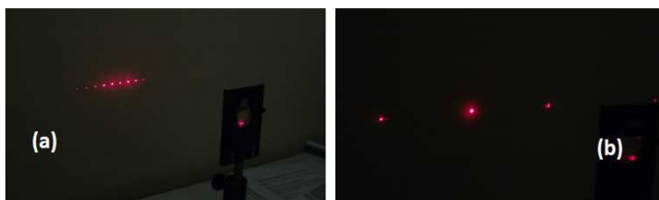
FIGURA 11. (a) Patrón de intensidades en una pantalla, obtenido en el laboratorio con una fuente láser y una red de 600 líneas por mm; (b) Patrón obtenido en el laboratorio con una fuente láser y una red de 1000 líneas por mm.
