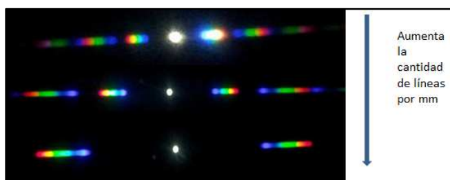
FIGURA 12. Fotografías de los patrones obtenidos en el laboratorio con distintas redes de difracción, mirando a través de la red una linterna de led alejada aproximadamente 5 m. Las fotografías se obtuvieron reemplazando el ojo por una cámara fotográfica.
