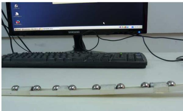
**FIGURA 1.** Montaje experimental del “acelerador magnético” usado en la práctica: canal de plástico, imanes de neodimio sujetos al canal y bolas de acero.
