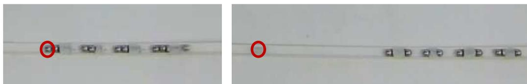
**FIGURA 4.** (a) Imagen mostrando la esfera que será lanzada al final del acelerador; (b) esfera lanzada 0,1 s después del impacto
