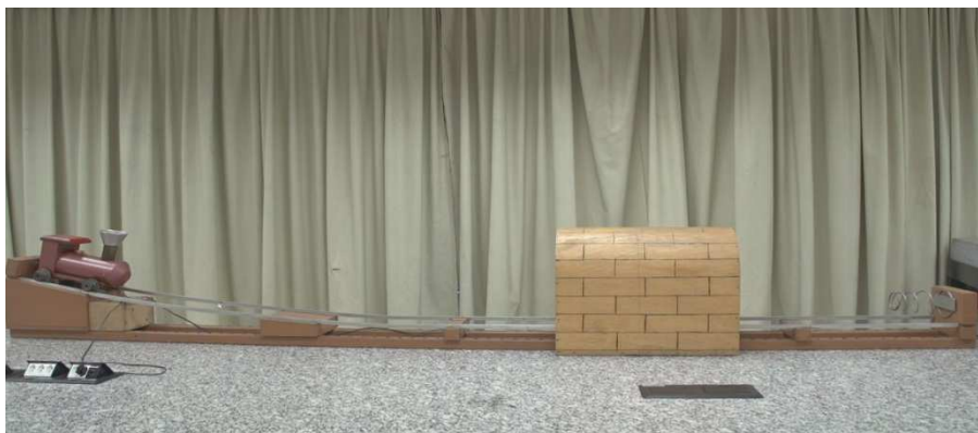
FIGURA 1. Aparato experimental básico: el carril, el túnel y la locomotora. Un disparador electromecánico es accionado y lanza verticalmente una esfera, que se encuentra dentro de la chimenea, poco antes de ingresar al túnel.
