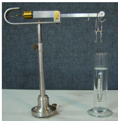
FIGURA 2. Balanza hidrostática de Mohr-Westphal
