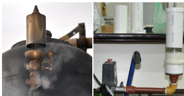
FIGURA 2. El silbato de bronce de la “Trochita” y la copia de PVC construida para el laboratorio de Física.
