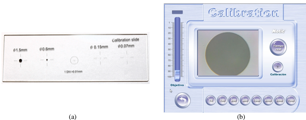
FIGURA 2. (a) Accesorio de calibración. (b) Punto patrón calibrado. Lente objetivo 10x.
