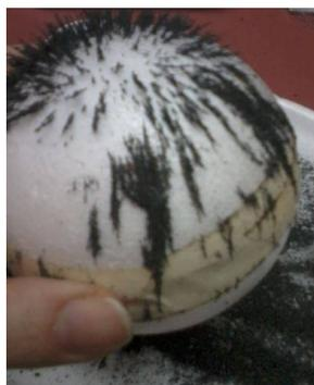
**FIGURA 4.** Esfera de telgopor con imán adentro simula ser la Tierra. Se pueden observar las líneas de campo tridimensionales.
