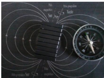
**FIGURA 3.** Dibujo de la Tierra y sus líneas de campo en una hoja con un imán real apoyado encima. Se puede observar la orientación de la aguja de la brújula según las líneas magnéticas.
