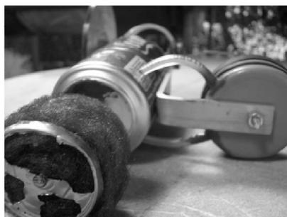
**FIGURA 4.** Imagen que muestra parte del diafragma, construido con una tapa agujereada y látex de un globo, y el desplazador hecho con virulana arrollada
