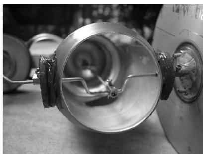
**FIGURA 5.** En esta imagen se observa el cigüeñal, y a la derecha el volante de inercia, hecho con CD usados
