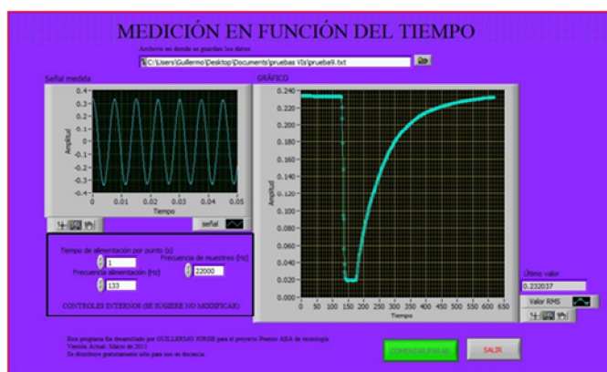
FIGURA 4. Imagen del programa de medición en un experimento real: ley de enfriamiento
