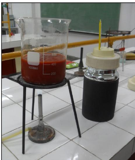
**FIGURA 2.** Calorímetro de mezcla del laboratorio de la Facultad de Ciencias de la Alimentación.
