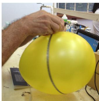
**FIGURA 5.** Medida del diámetro del globo
