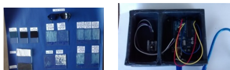
FIGURA 2. Na imagem da esquerda temos alguns elementos da montagem experimental da fase qualitativa do projeto. Na imagem da direita a montagem do sensor de UV do Arduino, utilizada para coletar dados quantitativos da 2ª fase do projeto.
