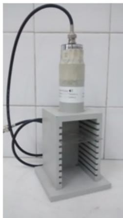
**FIGURA 2.** Soporte escalonado donde se ubican las muestras radiactivas. En la parte superior se coloca el tubo detector con los cables que llevan las señales al analizador monocanal.
