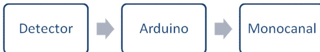
**FIGURA 5.** Diagrama en bloque de las acciones que siguen la señales desde que salen de la fuente radiactiva.
