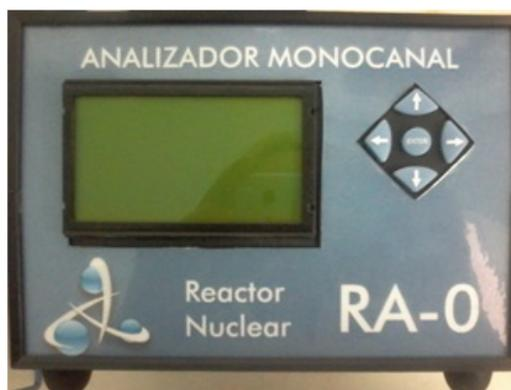
**FIGURA 3.** Analizador monocanal donde se procesa la información que llega del tubo detector.
