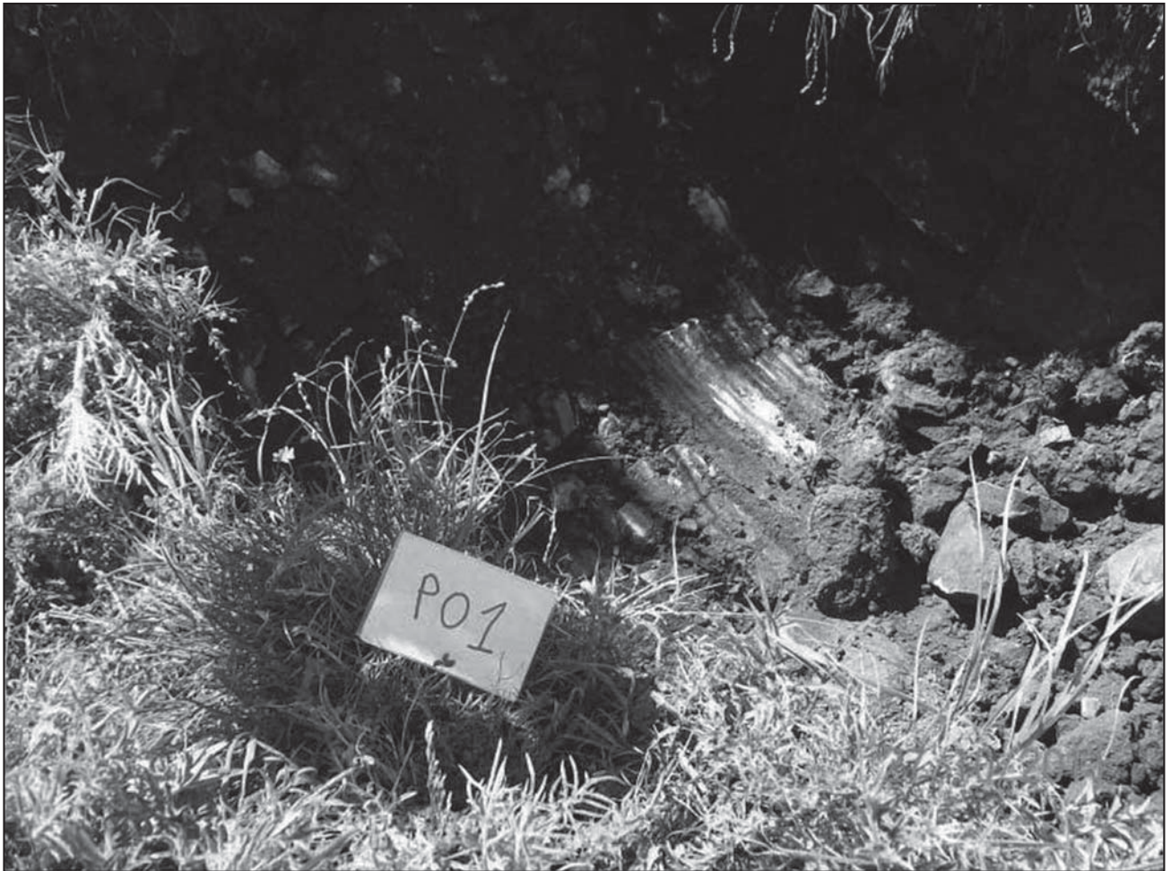
Figura 14. Punto Observación 1 (PO1) en Progresiva 45,95 m. Presencia de rocas del Basamento Cristalino Precámbrico bajo 0,3 metros de suelo vegetal.
