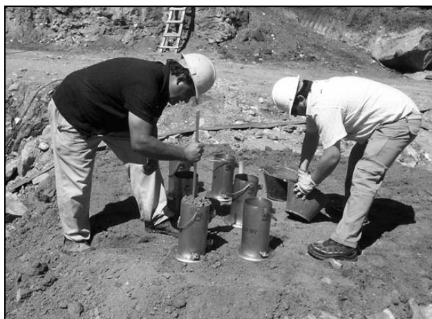
Figura 16. Tratamiento dental. Probetas de ensayo del hormigón H13 utilizado en la tarea de saneamiento.
