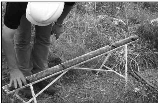
Figura 4. Sondeo S7 en el estribo de margen derecha. Testigo intrusivo aplítico milonitizado, de color rosado, grado de alteración A 1
