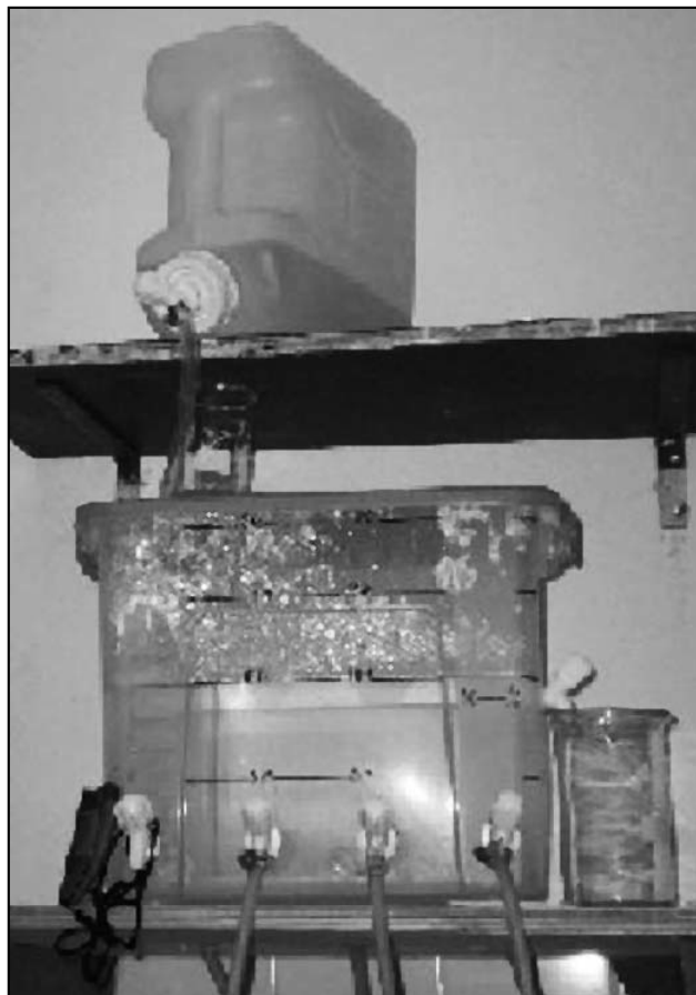
Figura 1. Sistema de reservatório do ensaio de coluna de lixiviação, composto de reservatório tanque, reservatório inferior, vazadouro, torneiras e cronômetro.
