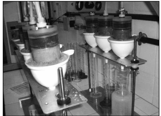
Figura 3. Sistema de filtração do percolado no ensaio de coluna de lixiviação.
