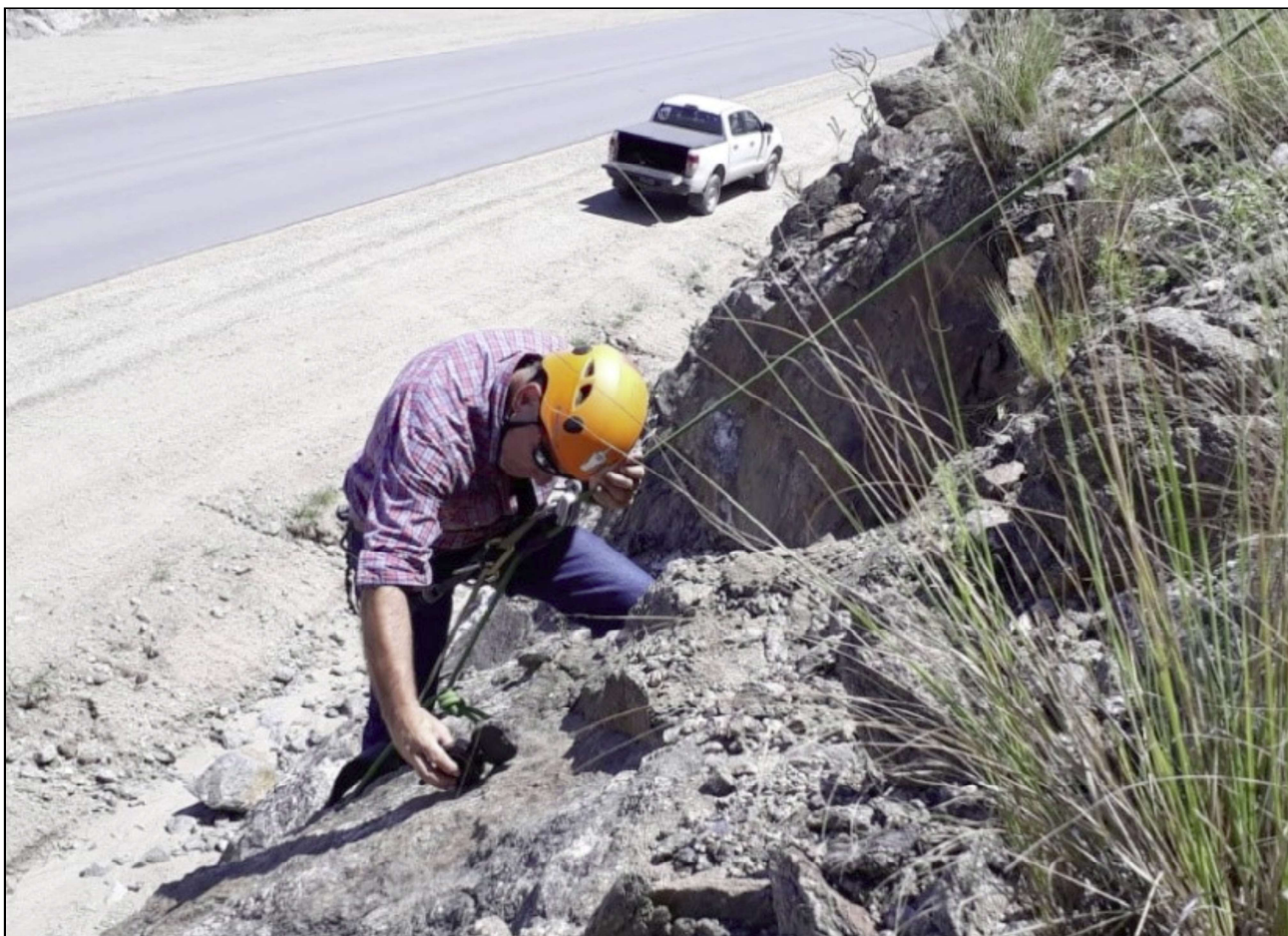
Figura 4. Medición de buzamiento con brújula geológica, en plano de discontinuidad desfavorable a la estabilidad. Toma de datos en EG 23 (31° 31.754 S - 64°30.060 O).
