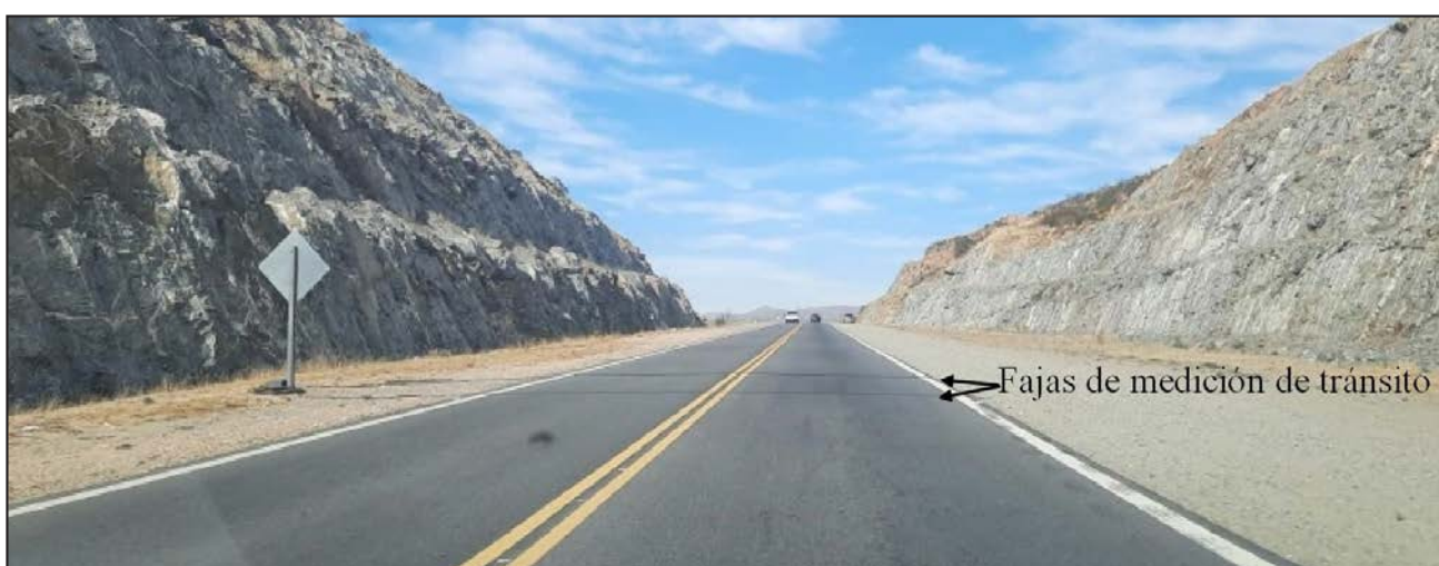
Figura 11. Medición del TMDA y Velocidad de los vehículos con equipo de la Dirección Provincial de Vialidad. Ubicación: (31°31'44.03" - 64°30'2.17") Orientación fotográfica hacia el Oeste.
