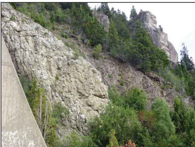
Figura 15. Sector norte de la Boca II. Se observa el elevado grado de fracturación y meteorización del macizo rocoso.
