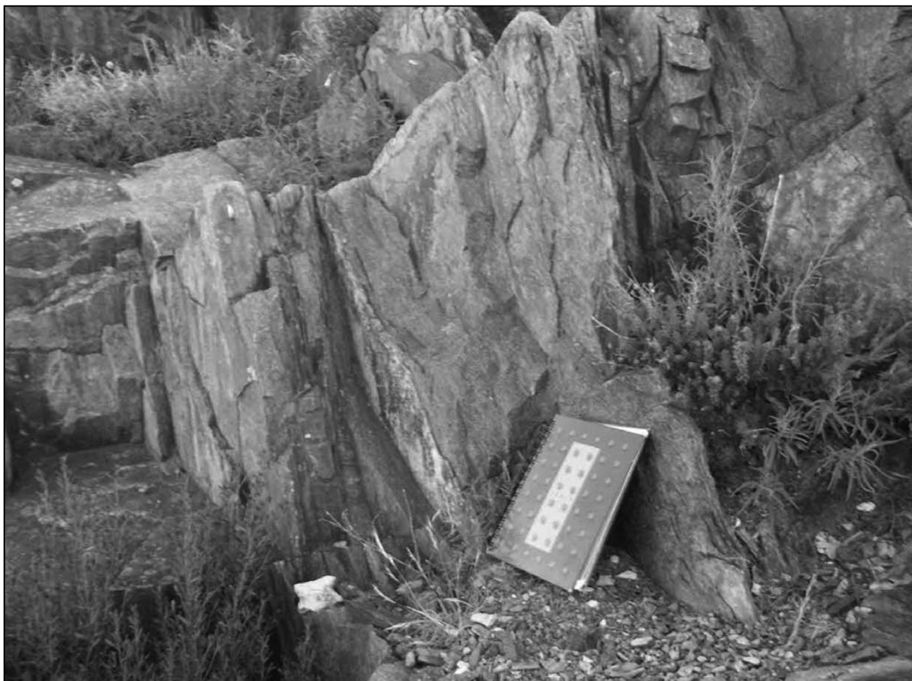
Figura 16. A° Blanco- Margen derecha- Rocas de grano muy fino, de color gris oscuro con presencia de lajosidad, tenaces y poco alteradas a inalteradas.
