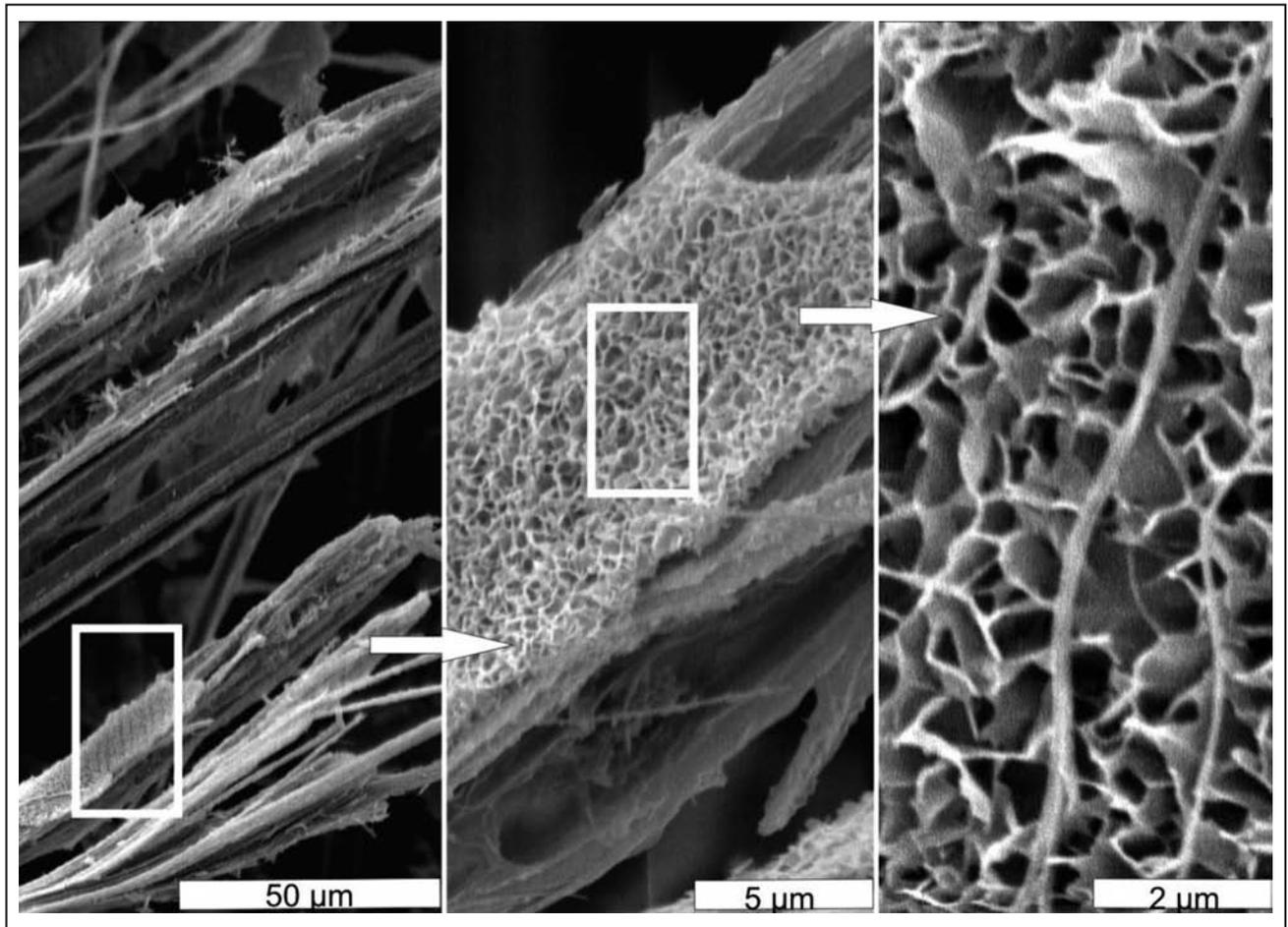
Figura 10. SEM del mineral tratado en autoclave a pH ácido. 10.a: fibras frágiles y corroídas. 10.b: Residuo originado durante el ensayo en la fibras. 10.c: detalle de la fase no cristalina.
