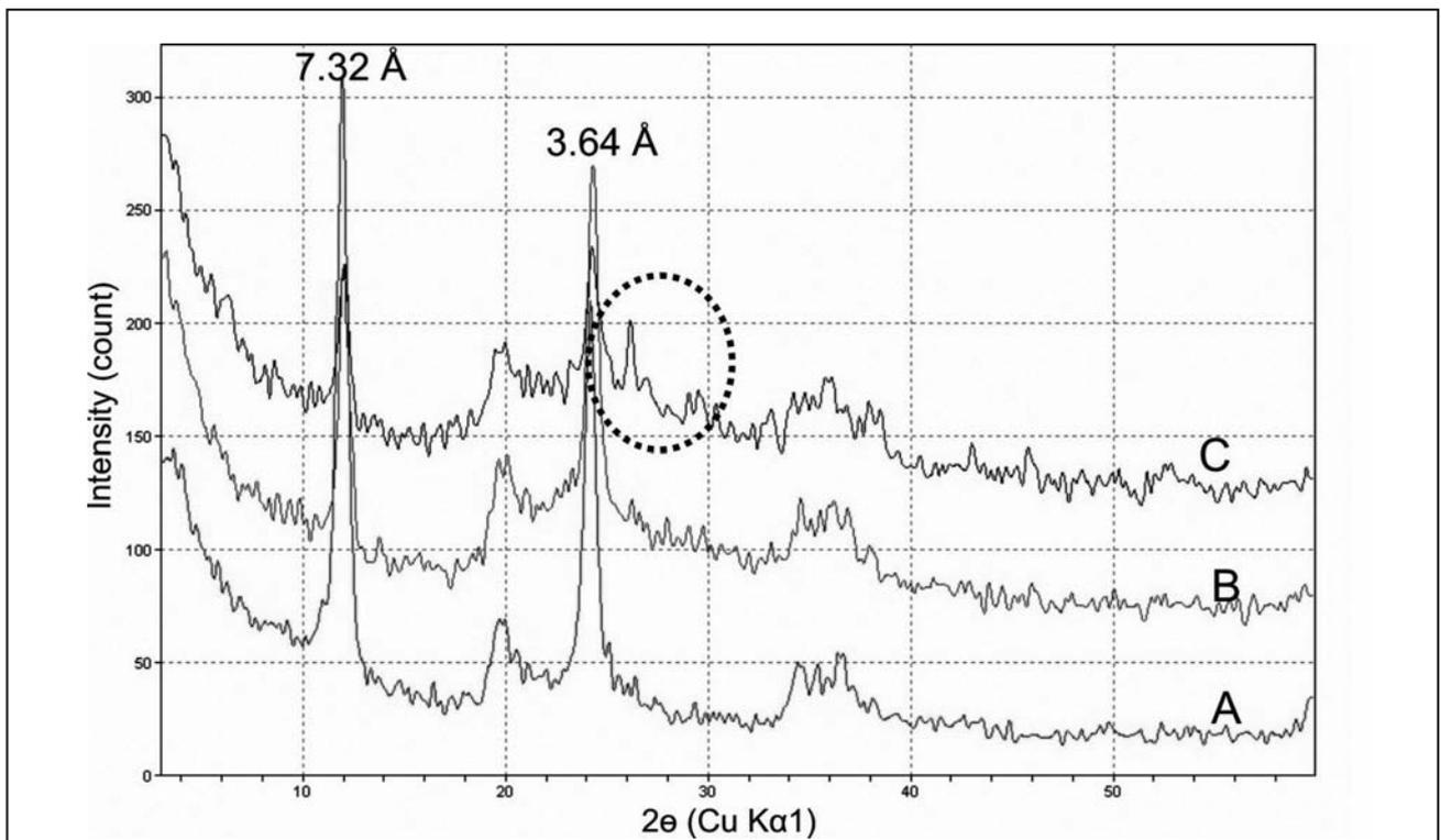
Figura 11. Difractometría de rayos X. A: crisotilo natural. B: pH alcalino. C: pH ácido.
