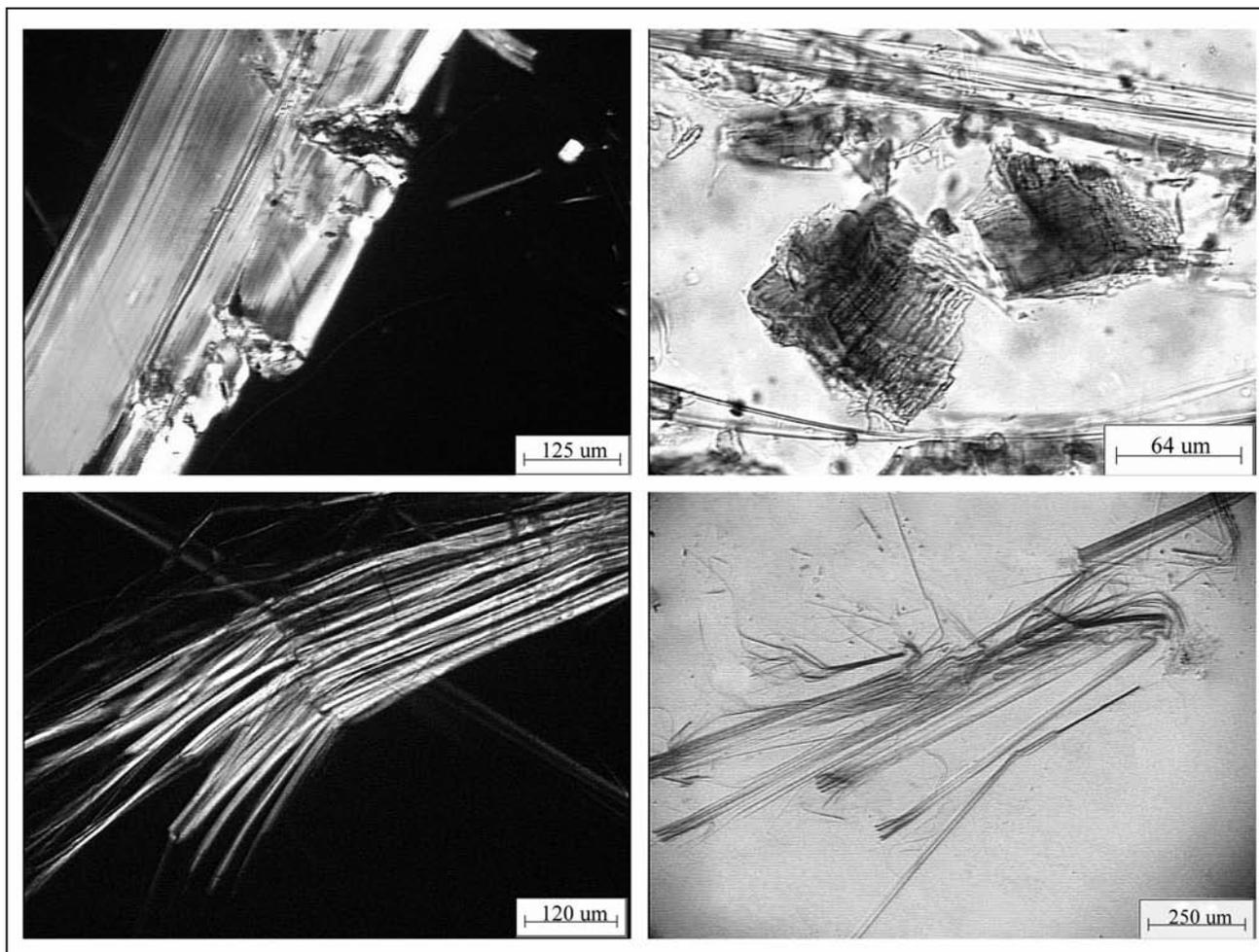
Figura 9. Ensayo en autoclave. 9.a: pH neutro. 9.b: residuo generado a pH neutro. 9.c: pH alcalino. 9.d: pH ácido
