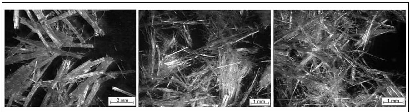
Figura 8. Dispersión por aire. 8.a: Paquetes de fibras naturales de crisotilo, pre tratamiento. 8.b: Fibras calcinadas a 300° y 20' y 8.c: 600° y 20'. Se observa separación de fibras a partir de los paquetes densos de las fibras naturales.
